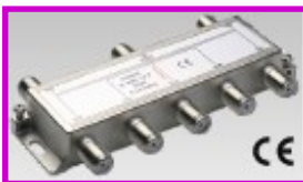
DERIVADOR F DE 6VÍAS BLINDADO. MARGEN DE FRECUENCIAS 5-2250 MHz. PASO DE CORRIENTE SÓLO EN PROLONGACIÓN (IN/OUT). F TAP
